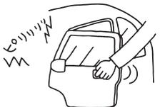
ドア、トランクが開けられるなどして、ルームランプが点灯した際に車両に流れる微小な電流変化をとらえて即サイレン音を鳴らします。ボリュームによる感度調整も可能。
