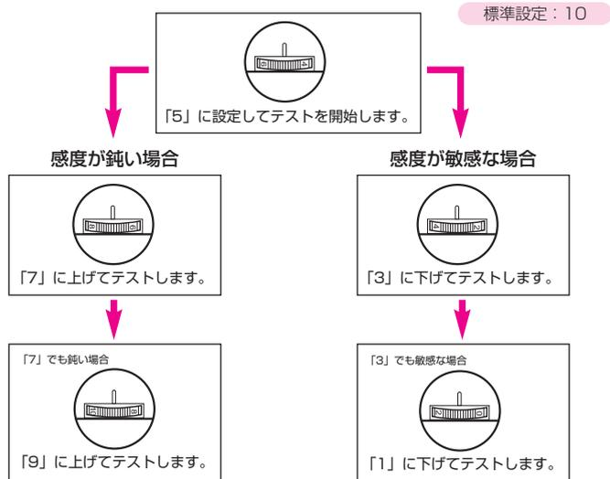
電流センサーの上手な感度設定の仕方——②
